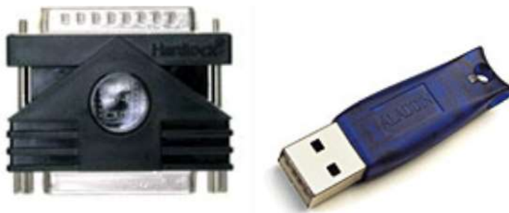
شکل ۳-۱: قفل سخت افزاری نرم افزار ELOP II برای پورت USB و پورت موازی
