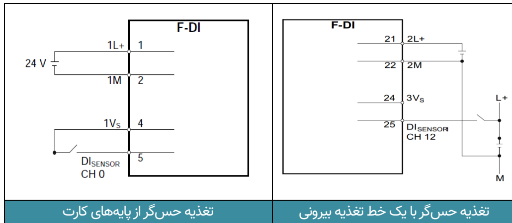
شکل ۸-۸: اتصال یک حس‌گر دیجیتال به یک کانال از کارت F-DI (طرح 1001)
